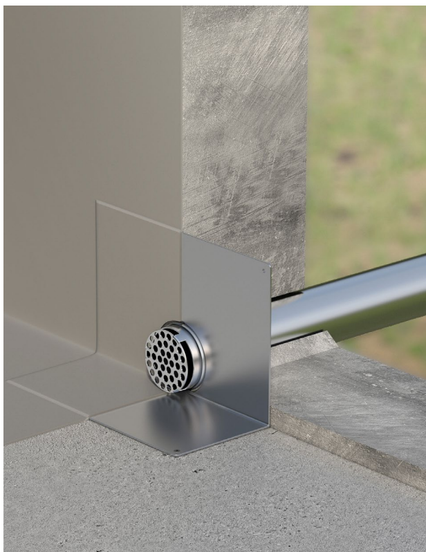
ACO Spout – gură de scurgere principală, instalată la nivelul pardoselii, etanșată cu adeziv de plastic lichid.
