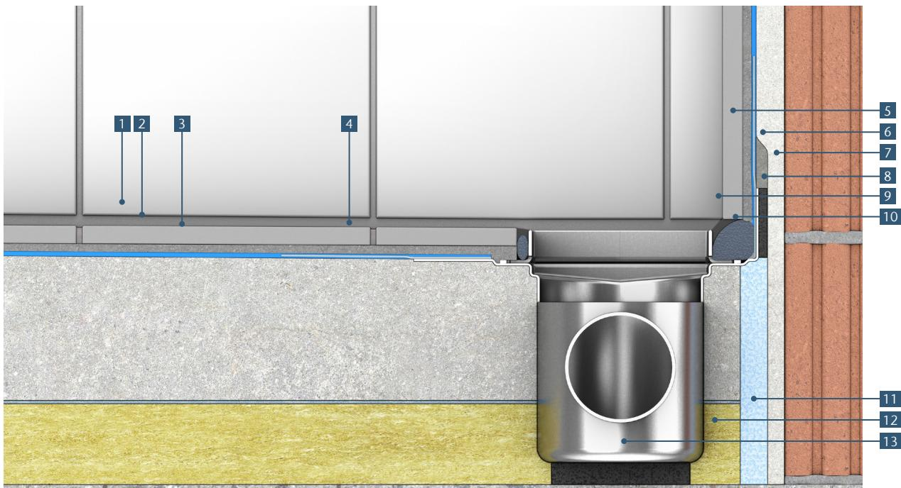
Sugestie de instalare cu izolare fonică
