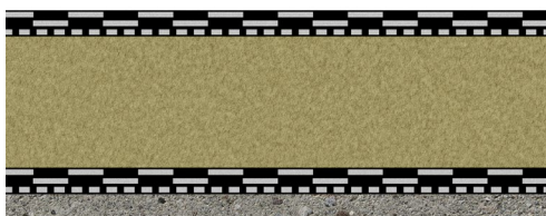
Placă de beton, membrană hidroizolatoare, termoizolație, membrană hidroizolatoare
