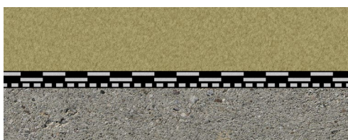
Terasă inversă. Placă de beton, membrană hidroizolatoare (tip PVC), termoizolație
