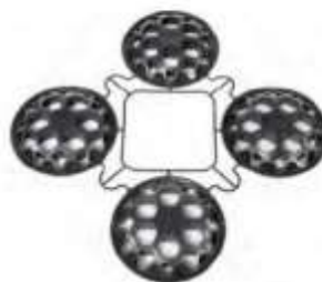
Capacele ACO Stormbrixx închid patru deschideri de coloană.
