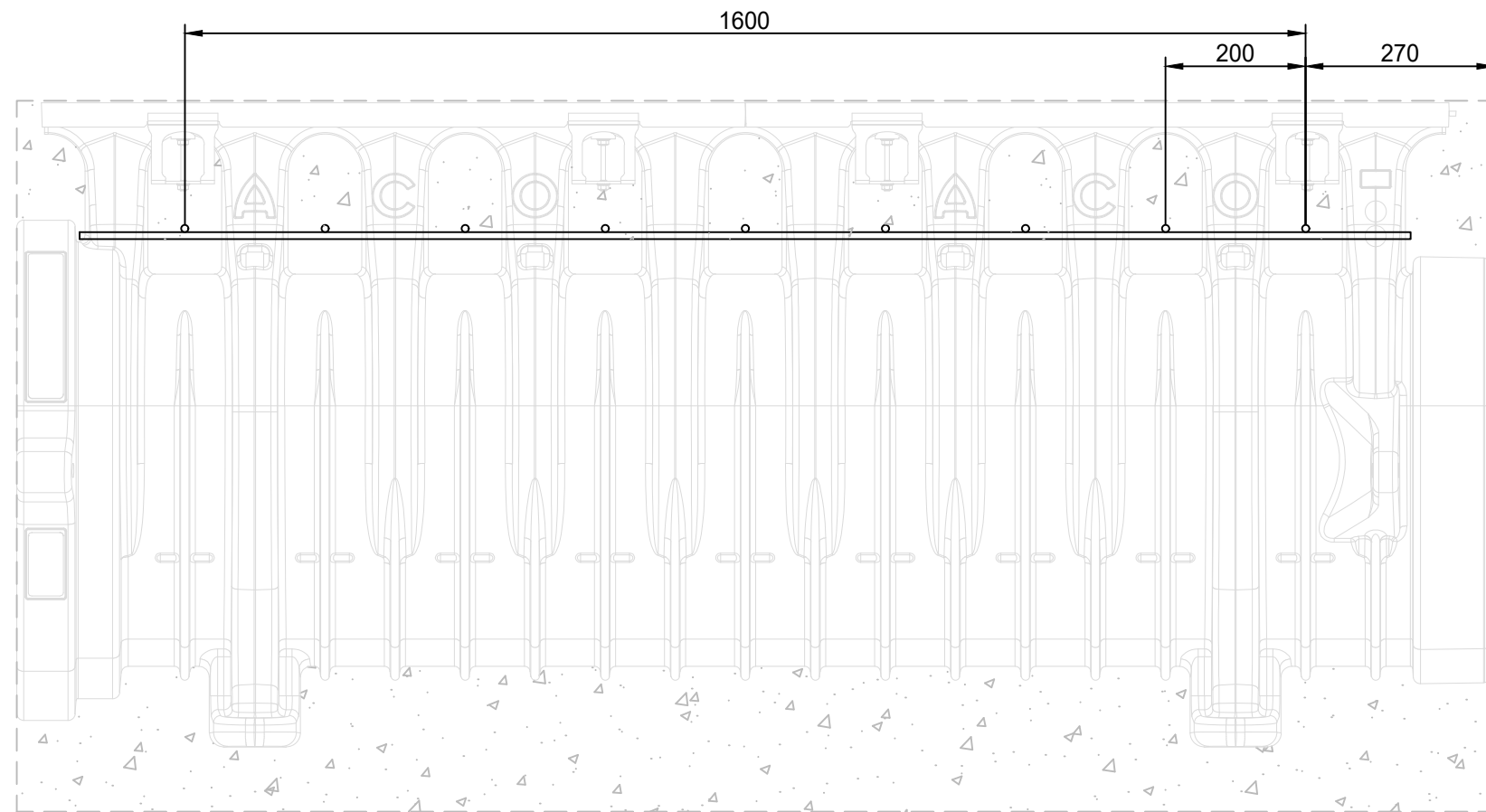
Vedere frontală - Ranforsare superioară Qmax 550
